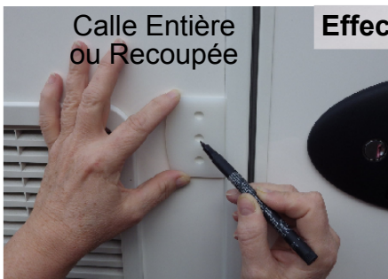
11 - Traçez et Percez 3 Trous Ø 9 Bien Perpendiculaire Et Parallèle
