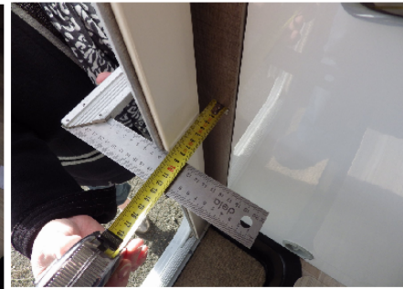
2 - Mesure de la Cote Maxi - Ici 87
