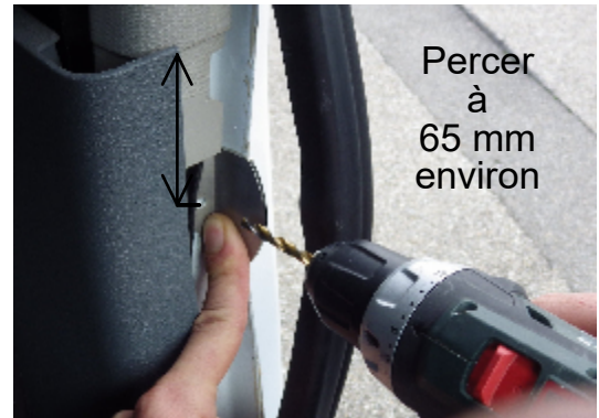
2 - Pointez le Renfort Bien en Appuis sur le côté puis Perçer à Ø 5
